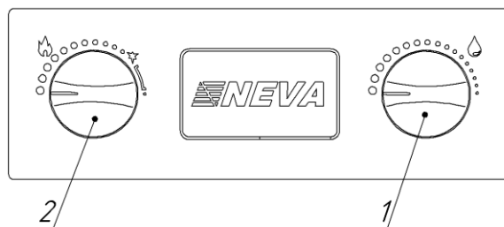
б) Ручки регулировки расхода воды 1 и расхода газа 2 в положении “Максимальный расход”
