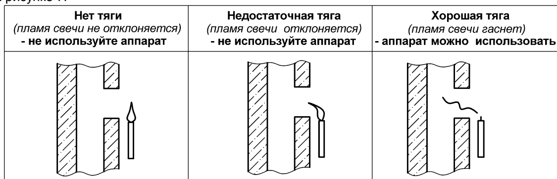
Рисунок 7. Способ проверки тяги в дымоходе
