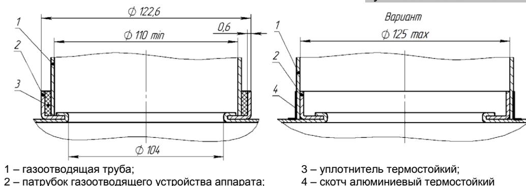
Рис. 7. Схема подсоединения газоотводящей трубы
