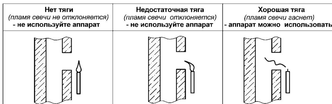
Рис. 4. Способ проверки тяги в дымоходе
