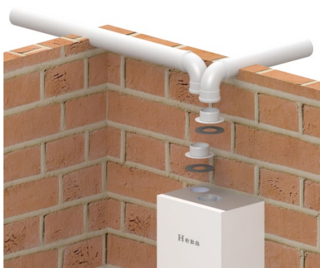
Рис. 4 Схемы присоединения отдельного дымохода Ø 80 мм к котлу
