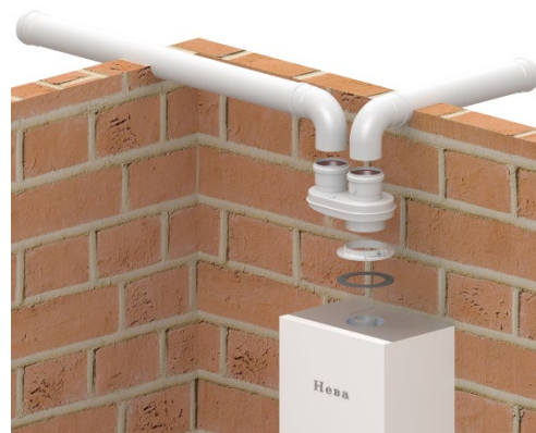
Рис. 4 Схемы присоединения отдельного дымохода Ø 80 мм к котлу
